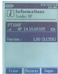
Les informations relatives à la sonde apparaissent à l'écran. A l'aide de la touche de fonction « **Mesures** » il est possible de revenir à l'écran des mesures. Il est aussi possible de supprimer la sonde RF en appuyant sur la touche de fonction « **Suppr.** ».
