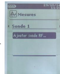
A l'aide des flèches de navigation sélectionner « **Ajouter sonde RF...** » puis appuyer sur **OK**
