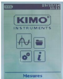
A l'aide des flèches de navigation, aller dans le menu « **Mesures** » puis appuyer sur **OK**
