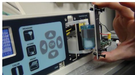
Le filtre de condensation est remplacé moins souvent que le filtre de ligne, mais il doit être remplacé dès qu'il est saturé en humidité. Pour accéder au filtre de condensation, retirer la partie supérieure du boîtier. Plus de détails sont disponibles dans le chapitre "Maintenance" (Chapitre 12) de la notice d'utilisation complète du Si-CA 8500.
