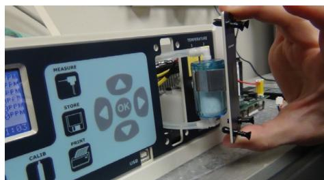
Der Kondensatfilter wird weniger häufig ersetzt als der Inline-Filter, muss aber ersetzt werden, sobald er mit Feuchtigkeit gesättigt ist. Um an den Kondensatfilter zu gelangen, entfernen Sie den oberen Teil Gehäuses. Weitere Einzelheiten siehe Kapitel "Wartung" (Kapitel 12) der vollständigen Gebrauchsanleitung des Si-CA 8500.
