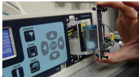
Il filtro di condensa viene in genere sostituito molto meno frequentemente del filtro di linea e deve essere sostituito se si satura di acqua. È possibile accedere a questo filtro aprendo l'analizzatore. Maggiori dettagli sono disponibili nella sezione Manutenzione (capitolo 12) del manuale utente completo Si-CA 8500.
