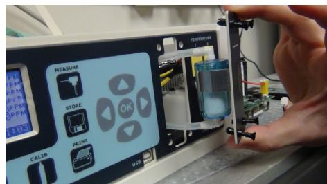
Aunque no requiere cambios tan frecuentes como el filtro de línea, el filtro de condensación debe sustituirse cuando se satura de humedad. Para acceder al filtro de condensación, retire la parte superior de la carcasa. Encontrará más detalles en el Capítulo 12 "Mantenimiento" del manual de utilización completo del Si-CA 8500.
