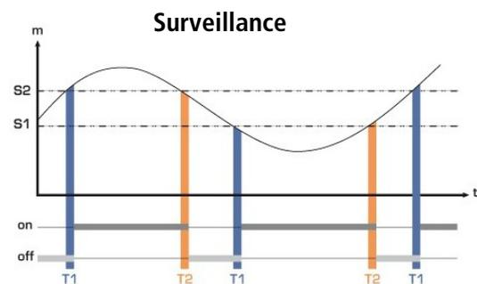
Le relais se déclenche lorsque la mesure est en dehors du seuil haut et du seuil bas.
