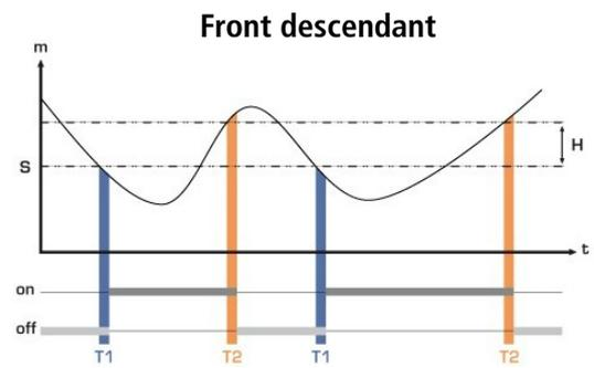
Mesure (m) < Seuil (S) pendant la temporisation T1 → Déclenchement du relais.
