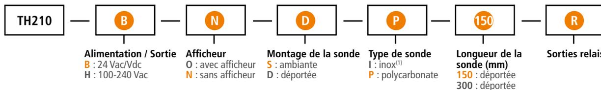
Exemple : TH210 – BNDP150 – R : Capteur/transmetteur d'hygrométrie et température, alimentation 24 Vac/Vdc, sans afficheur, avec sonde déportée en polycarbonate de longueur 150 mm et sorties relais.
