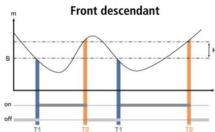
Mesure (m) < Seuil (S) pendant la temporisation T1 : Activation de l'alarme.
