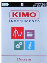
A l'aide des flèches de navigation, aller dans le menu « Mesures » puis appuyer sur OK
