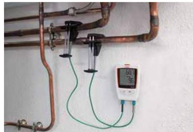
KTT 220 équipé de deux sondes thermocouple à pince pour le contrôle du réseau d'eau chaude sanitaire (ECS), sur platine de fixation murale.
