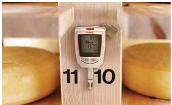
*Contrôle en humidité relative et température en cave d'affinage, assuré par un KH 220 fixé sur platine de fixation et sécurisé par un cadenas dans le cadre d'une cartographie.*
