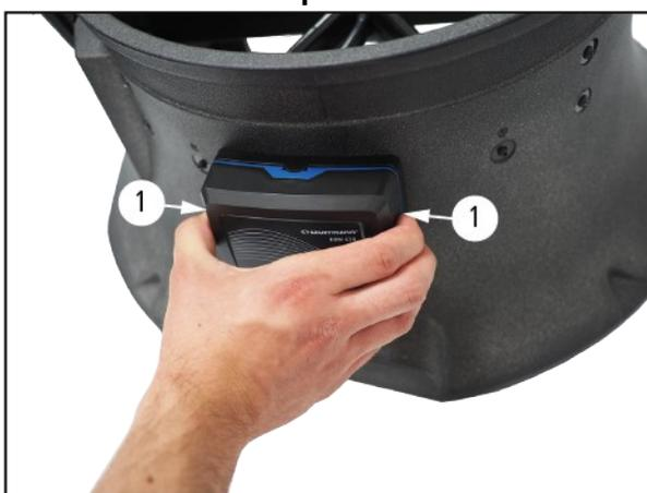
1. 2 clips plastiques permettant sa fixation sur la base (mode débitmètre)
