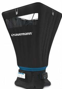
Ces hottes sont étanches et contiennent une bande transparente face à l'utilisateur permettant de voir à travers la bouche d'aération et ainsi de s'assurer que la hotte est bien en place. Les tiges, réalisées en fibre de carbone, assurent la bonne rigidité des hottes.
