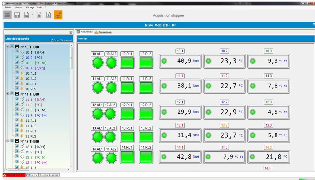
La représentation synoptique rassemble les esclaves et les alarmes sur la même visualisation sous forme de croquis personnalisables. Il est ainsi possible de localiser en temps réel les valeurs mesurées et les alarmes.
